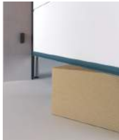
Zabezpieczenie przeciążeniowe w bramie automatycznej
